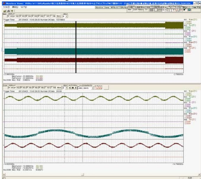
FIGURE 10. CATCH-SPIN WAVEFORMS
